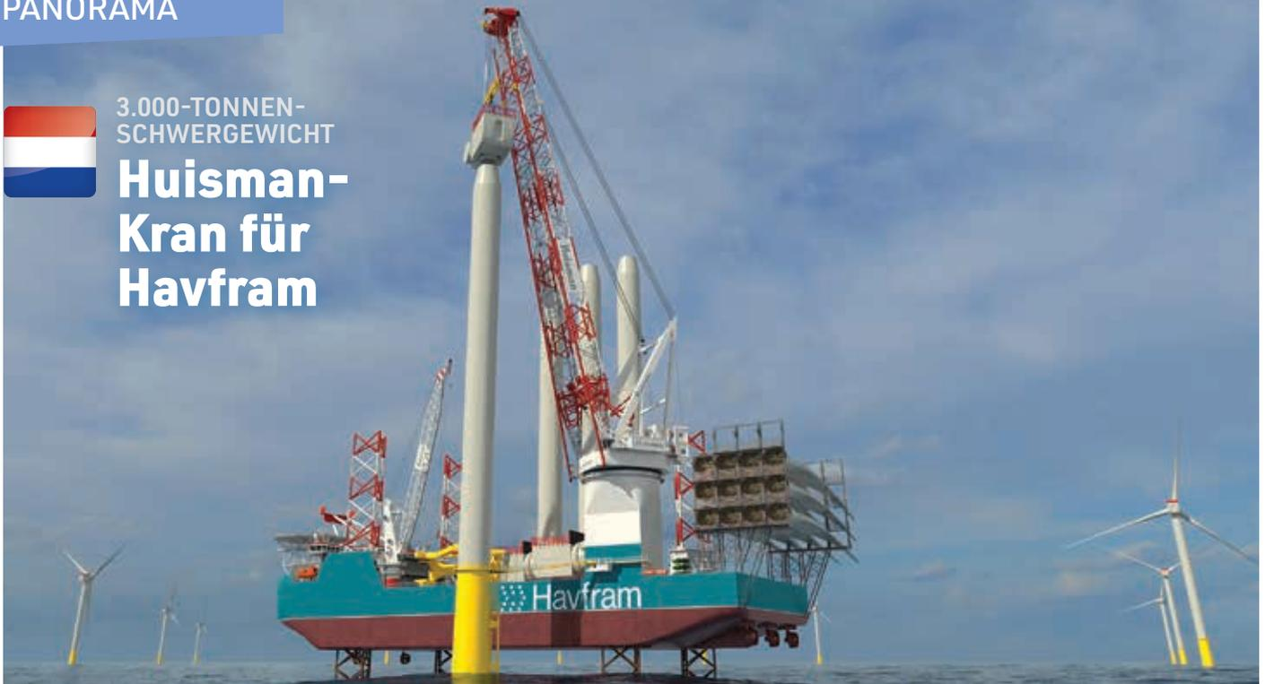
Das Offshore-Turbinen-Installationsunternehmen Havfram Wind hat beim niederländischen Schwerlastkranhersteller Huisman einen Leg Encircling Crane (LEC) mit 3.000 Tonnen Tragkraft bestellt. Es handelt sich um den zweiten Kran, der für eines der NG-20000X-Windturbinen-Installationsschiffe bestellt wurde, die von CIMC Raffles gebaut werden. Der vollelektrische Kran wird mit einem
