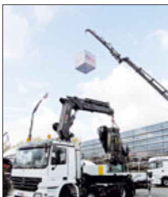
Der XS 600 hat den neuen 100-mt-Kran XS 1055 am Haken
