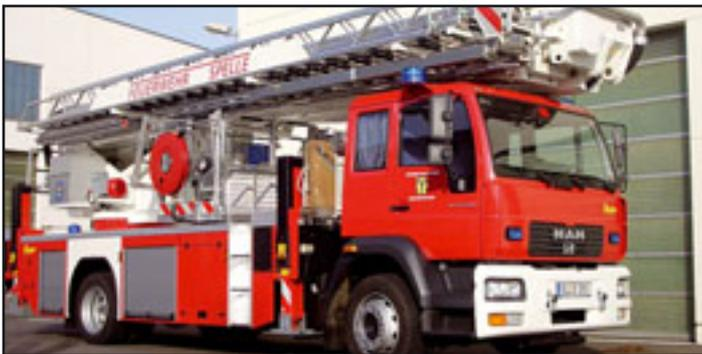
Eine Teleskophubrettungs- bühne vom Typ F 32 RLX hat der finnische Hersteller an die Feuerwehr Spelle in Niedersachsen ausgeliefert. Das Hubrettungs- fahrzeug, eine Teleskop- bühne mit Gelenk- arm mit einer maximalen Ret- tungshöhe von 32 Metern, ist auf einem 18-Tonner von MAN montiert. 23 Meter maximale Reich- weite bietet das Modell. Nach Lie-
