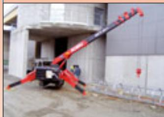
Neu in der Vermietflotte von Robru Arbeitshebebühnen ist ein Unic-Miniraupenkran vom Typ UR-A376 CLE. Der geländegängige Kran sei eine gute Lösung bei engem und auch schwer zugänglichem Terrain, so die Firma mit Sitz in Trimmis bei Chur. Dank der niedrigen Durchfahrts- und -breite ist er sogar für den Innenbereich geeignet. Seine maximale Hakenhöhe liegt bei 14,40 Meter. Bis zu 2,9 Tonnen
