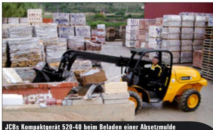
**JCBs Kompaktgerät 520-40 beim Beladen einer Absetzmulde**
