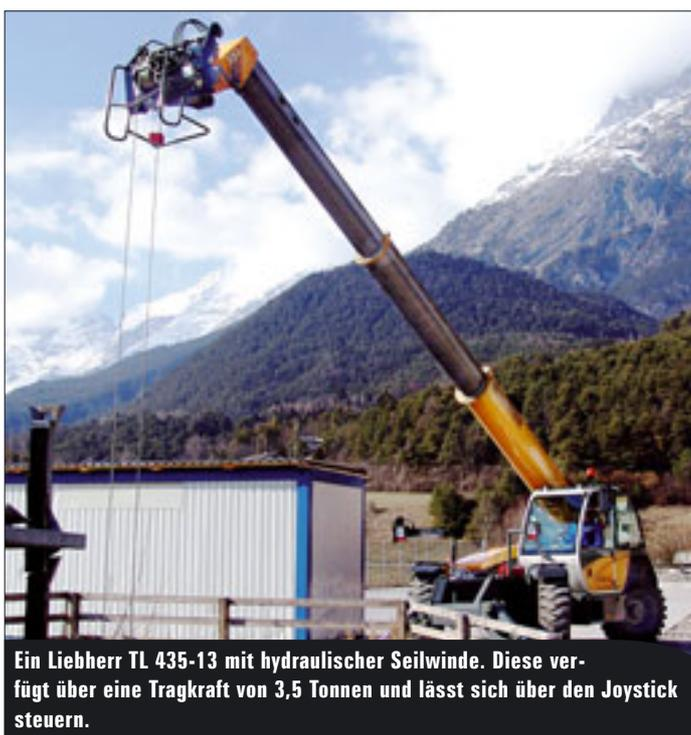
**Ein Liebherr TL 435-13 mit hydraulischer Seilwinde. Diese verfügt über eine Tragkraft von 3,5 Tonnen und lässt sich über den Joystick steuern.**
