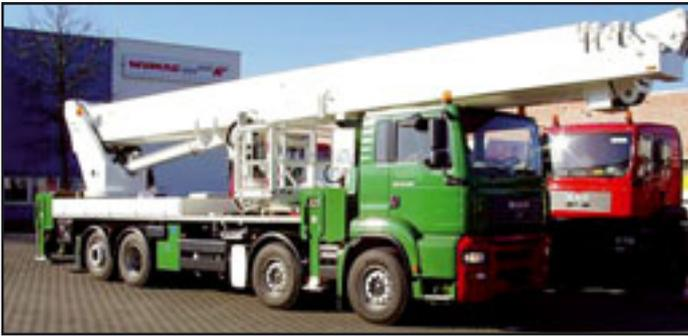
Im April wird Wumag Elevant erstmals die neue WT 700 der Öffentlichkeit vorstellen. Gegenüber dem Vorgängermodell weist diese 70-Meter-Schwerlastbühne Horizontal-Vertikal-Stützen mit kontinuierlichen Abstüzbreiten auf, also eine voll-variable Steuerung mit automatischer Reichwei-
