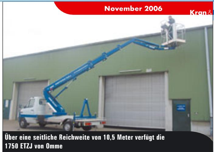
Über eine seitliche Reichweite von 10,5 Meter verfügt die 1750 ETZJ von Omme
