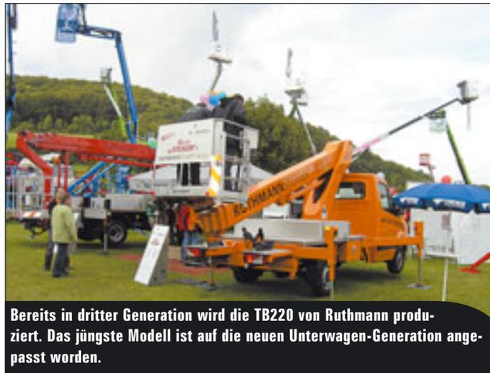
Bereits in dritter Generation wird die TB220 von Ruthmann produziert. Das jüngste Modell ist auf die neuen Unterwagen-Generation angepasst worden.
