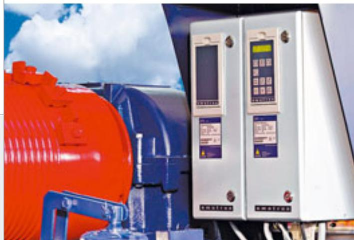
Die jüngste Generation von Frequenzumrichtern der schwedischen Firma Emotron kommt mit kompakteren Maßen und erweiterten Funktionen. Der VFX wurde speziell für dynamische Anwendungen wie Krane und dergleichen entwickelt. Die Geräte verfügen über Gehäuse mit
