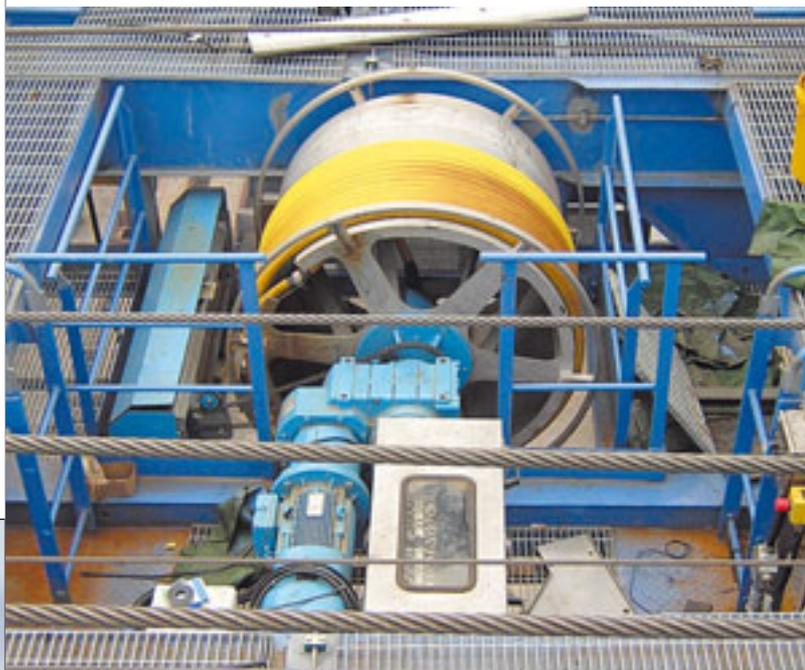
Nexans hat zwei neue Steuerleitungen für Trommelspreader-Anwendungen vorgestellt. Die eine, Rheycord Spreader Bus, verfügt über eine integrierte Busleitung, mittels der sich ein eventueller Bruch einzelner Adern oder Litzen während der dynamischen Beanspruchung
