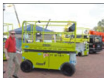
Itecos neue IT 8151, eine kompakte Elektroschere für Außeneinsätze
