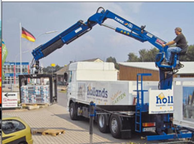
Bei der Entscheidung, neu in den Fuhrpark zu investieren, setzt die Hollands GmbH aus Herzogenrath einerseits auf Gewohntes, andererseits geht sie neue Wege. Als Chassis entschied sich das Unternehmen wieder für DAF. „Beim Ladekraufbau haben wir gewechselt. Die Hauptsäule des heckmontierten Ladekrans wollten wir mittig angeordnet haben.“ Der
