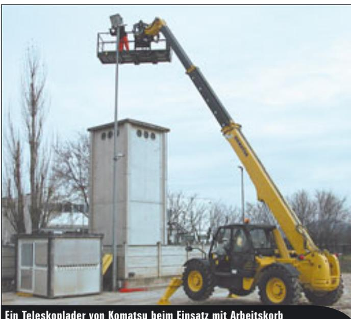
Ein Teleskoplader von Komatsu beim Einsatz mit Arbeitskorb
