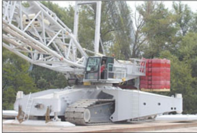
Stützmaten für die Stützen sind vorhanden. Auffällig sind die seitlichen hochklappbaren Stützen, ebenso mit Stützmaten. Durch einen niedrigeren Schwerpunkt – das Gegengewicht wird einen Meter tiefer als beim Standard-
