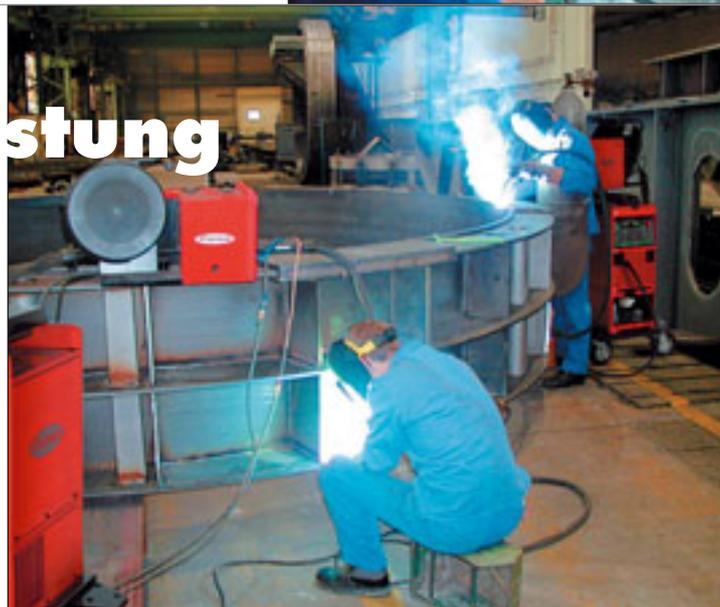
Schweißens ist die Art des Schutzgases. Je nach Prozess und Randbedingungen empfehlen die Experten von Fronius 2-Komponentengase auf Basis Argon/CO2 oder 3/4-Komponentengas auf Basis Argon/CO2/O2/Helium. Auch hier zeigen sich die Vorteile der Digitaltechnologie: Für zahlreiche Schutzgas-Mischungen
