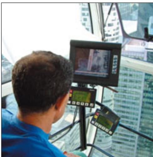
stützung (also nur per Funkkontakt zu einem am Boden befindlichen Einweiser). Ergebnis: mit Kamera stieg die Leistung um über 20 Prozent. Zu erledigende Hub- und Absetzarbeiten waren um über 20 Prozent schneller und zudem noch exakter absolviert als ohne dieses Hilfsmittel.
