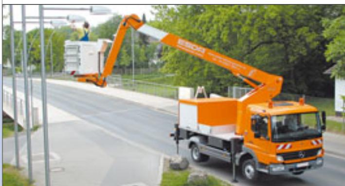
Die ESDA Fahrzeugwerke GmbH hat die weltweit erste Hubarbeitsbühne auf einem mit BlueTec und Euro 4 Motor ausgerüstetem LKW vorgestellt. Als Unterwagen dient ein Mercedes Benz Atego 816, auf den ESDA eine 17 Meter-Arbeitsbühne vom Typ TG 1700 S mit Gerätekofer montiert hat. Der Arbeitskorb der Bühne besteht aus glasfaserverstärktem Kunststoff und ist serienmäßig
