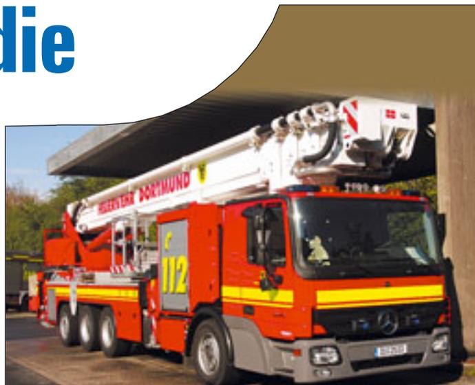
**Das derzeit höchste bei einer öffentlichen Feuerwehr in Deutschland eingesetzte Hubrettungsgerät lieferte die Fa. Bronto Skylift an die Feuerwehr der Stadt Dortmund. Das Gerät des Typs F 54 RLX mit einer Rettungshöhe von 54 Meter ist auf einem MercedesBenz Actros aufgebaut, an das serienmäßige 3-Achsfahrgestell eine gelenkte Nachlaufachse angesetzt wurde.**
