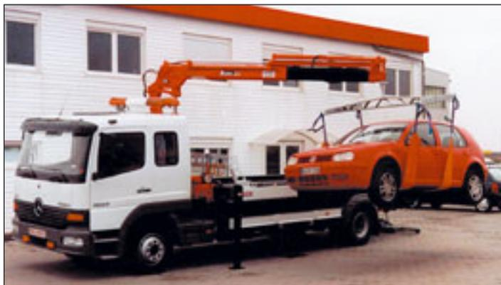
Mit dem neuen Euro 91 T Carlift stellt Tirre Krantechnik einen neuen Kran speziell für Berge- und Abschleppdienste vor. Der Kran, der sich auf einen 7,5-Tonner aufbauen lässt, verfügt über eine
