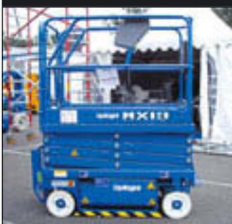
besonderer Wert auf die „Türgängigkeit“ gelegt wird, also darauf, dass die Bühne in eingefahrenem Zustand problemlos durch eine normale Tür passt. Egal, ob für eine solche Durchfahrt die Sicherheitsgeländer der Arbeitsplattform abgeklappt werden müssen oder ob die Bühne soweit zusammengefahren werden kann: Die Tür ist das Maß aller Dinge.
