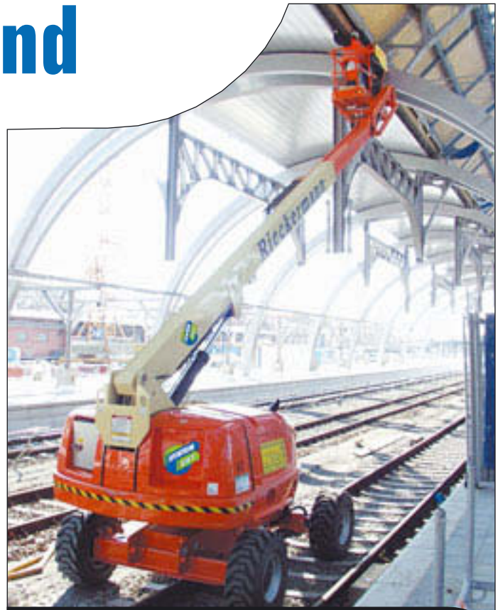
Bei Arbeiten an der Dachkonstruktion über den Schienen mussten die zum Einsatz kommenden Geräte eine hohe Bodenfreiheit haben, um die Höhe der Bahnschienen zu überwinden. So kamen Teleskopbühnen mit einer Arbeitshöhe von 16 bis 20 Metern und Gelenkteleskopbühnen mit 20,50 Meter Arbeitshöhe zum Einsatz. Der System Lift-Partner Rieckermann & Sohn hatte zeitweise bis zu sieben Geräte im Einsatz.
