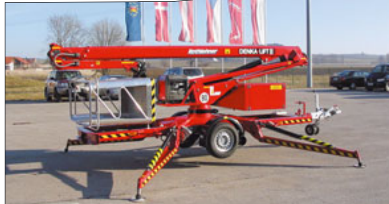
Die Denkalift DLX 15 dank herabgeklapptem Korb hat eine Transportlänge von 6,3 Metern
