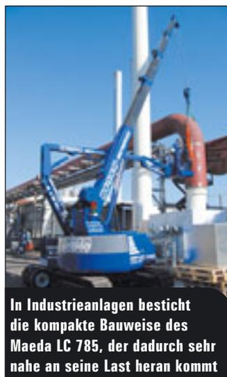
**In Industrieanlagen besticht die kompakte Bauweise des Maeda LC 785, der dadurch sehr nahe an seine Last heran kommt**
