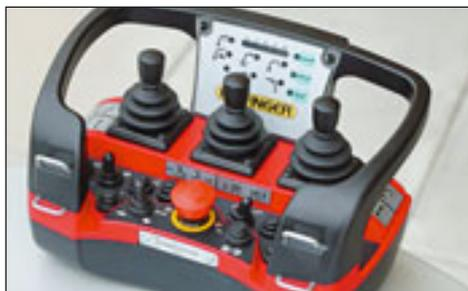
zulegen – sprich, es müssen vom Kranfahrer mindestens zwei Tasten aktiviert werden, um bestimmte Manöver ausführen zu können. Zusätzlich lässt sich die Maximal-Geschwindigkeit der unterschiedlichen Kranbewegungen in drei Stufen reduzieren.
