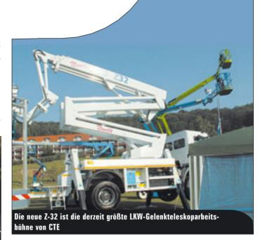
Die knapp 48 Tonnen Gewicht werden auf fünf Achsen verteilt, wobei auf ein Standard-Vierachs-Fahrgestell zurückgegriffen wird, dem eine gelenkte Nachlaufachse hinzugefügt wird. Darüber hinaus ist mit der XDT-Serie die Modellpalette zwischen 37 und 70 Metern Arbeitshöhe unlängst überarbeitet worden. Allen Modellen gleich ist die maximale Korblast von 700 Kilogramm sowie die neue Steuerung.
