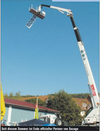
werden. Die Korblast von 250 Kilogramm steht für den gesamten Arbeitsbereich uneingeschränkt zur Verfügung. Als Untergestellt dient ein 18-Tonner. Mit 8,25 Metern Gesamtlänge ist die Bühne recht kompakt.
