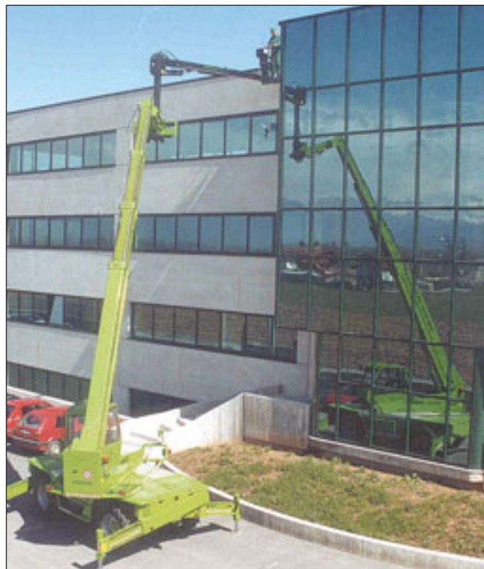
Teleskoplader wie der Merlo 4018 ersetzen mit dem entsprechenden Zubehör oft herkömmliche Arbeitsbühnen
