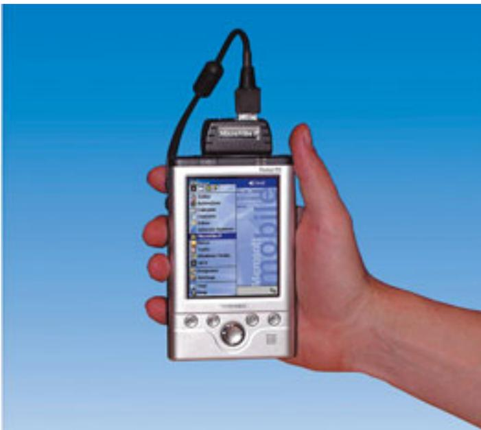
SKF hat ein neues Schwingungsmess- und Analysesystem vorgestellt, das MicroVibeP. Es verbindet nach Herstellerangaben die Vorzüge eines Standard PDA (Personal Digital Assistant) mit der langjährigen SKF Erfahrung im Bereich der Maschinen- und Wälzlagerdiagnose. Es besteht aus einer Einsteckkarte im Compact Flash Typ 2 (CF Typ 2) Format, einem Beschleunigungsaufnehmer sowie entsprechenden Software-Komponenten für PDA und PC. Nach der einfachen Installation der
