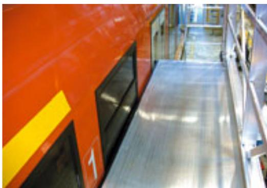
Wartungstätigkeiten an diesen Fahrzeugen werden so erleichtert - im Ein-Mann-Betrieb. Dabei ermöglicht die feinfühligste Steuerung das so genannte "Spaltmaß null" - zwischen der Bühne und dem Objekt entsteht ein Übergang ohne Zwischenraum. Basis der elektrisch verstellbaren Arbeitsbühnen von Günzburger
