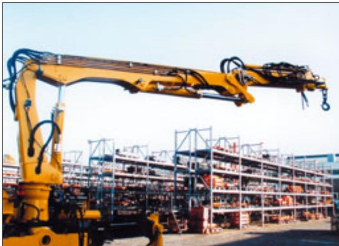
Metern. Der Ladekran hat einen zweifach hydraulischen Knickarm und eine speziell angepasste Abstützung; auf der einen Seite die Standardversion, auf der anderen eine Pratzabstützung zum Ausgleich des Kraftbedarfs bei Erdbohr- oder Mastaufstellarbeiten. Terex-Atlas baut nach eigenen Angaben derzeit 36 Basismodelle in 210 unterschiedlichen Varianten und liefert in 60 Länder. Für das Jahr 2005 soll die Fertigungskapazität des Werkes um 30 Prozent erhöht werden.
