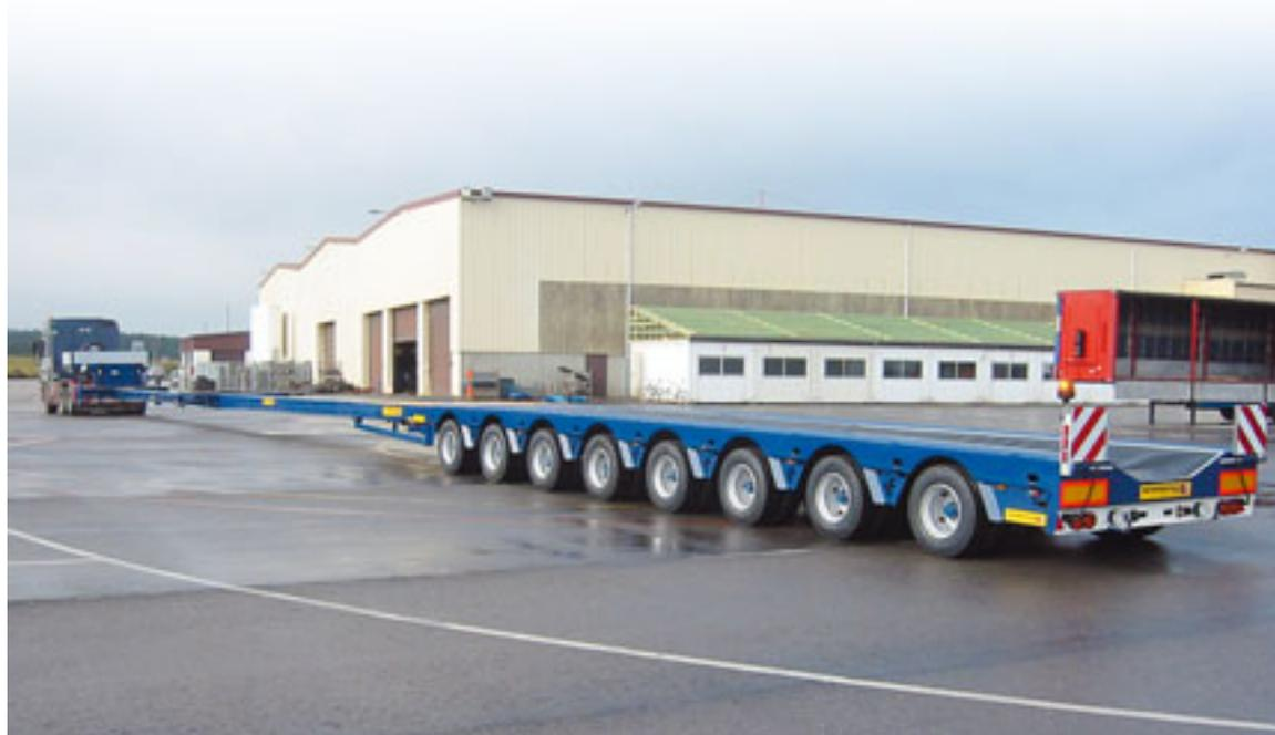
Der Transport von Windkraftanlagen erfordert neben entsprechendem Know-how auch besonderes Equipment. So hat Faymonville für den besseren Transport des Turmes solcher Anlagen sein Aufliegermodell Multimax weiterentwickelt. Ziel war eine bessere Lastverteilung
