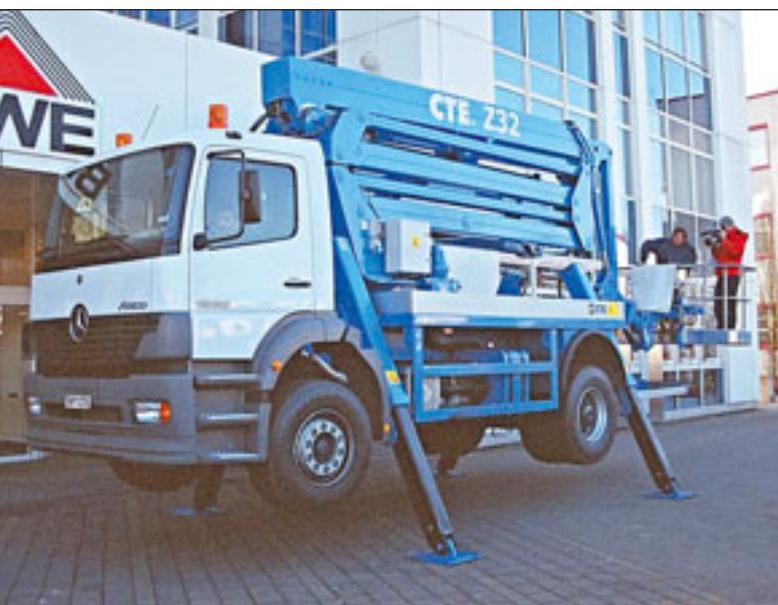
Erstmals in Deutschland zu sehen war die neue Z 32 Gelenkbühne auf LKW-Basis von CTE. Daten nach Angaben des Herstellers: 32 Meter Arbeitshöhe, 20 Meter seitliche Reichweite sowie 250 Kilogramm Korblast.
