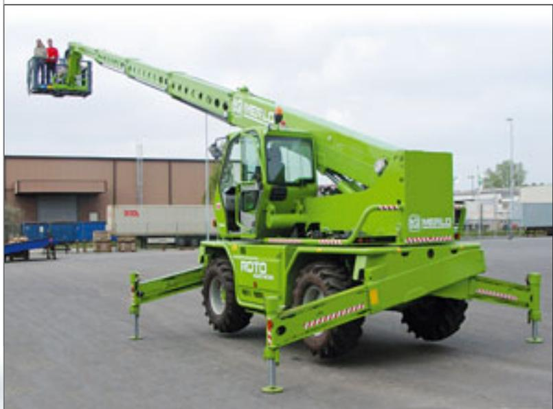
Für das inzwischen rund 30 Maschinentypen umfassende Teleskopmaschinenprogramm von Merlo stellt die ROTO 40.25 MCSS nach Herstellerangaben einen Entwicklungshöhepunkt dar. Die maximal vier Tonnen hebende und über 25 Meter Hubhöhe erreichende Maschine schließt nach Ansicht des Herstellers die Lücke zwischen Universalbaumaschine und kompaktem Mobilkran. Auch dieses Modell wurde als schnell umrüstbarer Ausrüstungsträger konzi-
