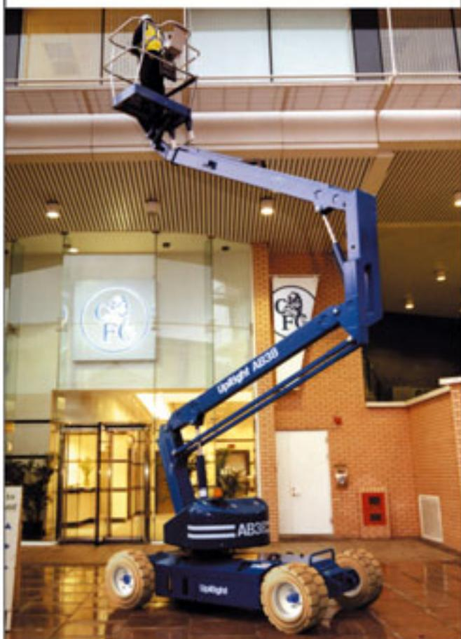
**UpRight International's AB38/AB38 Lite** Elektrobühnen sind Kraftpakete. Bepackt mit in dieser Klasse führenden Features. Die AB38 Elektrobühne hat 13,5m Arbeitshöhe und 6,1m Arbeitsreichweite.
