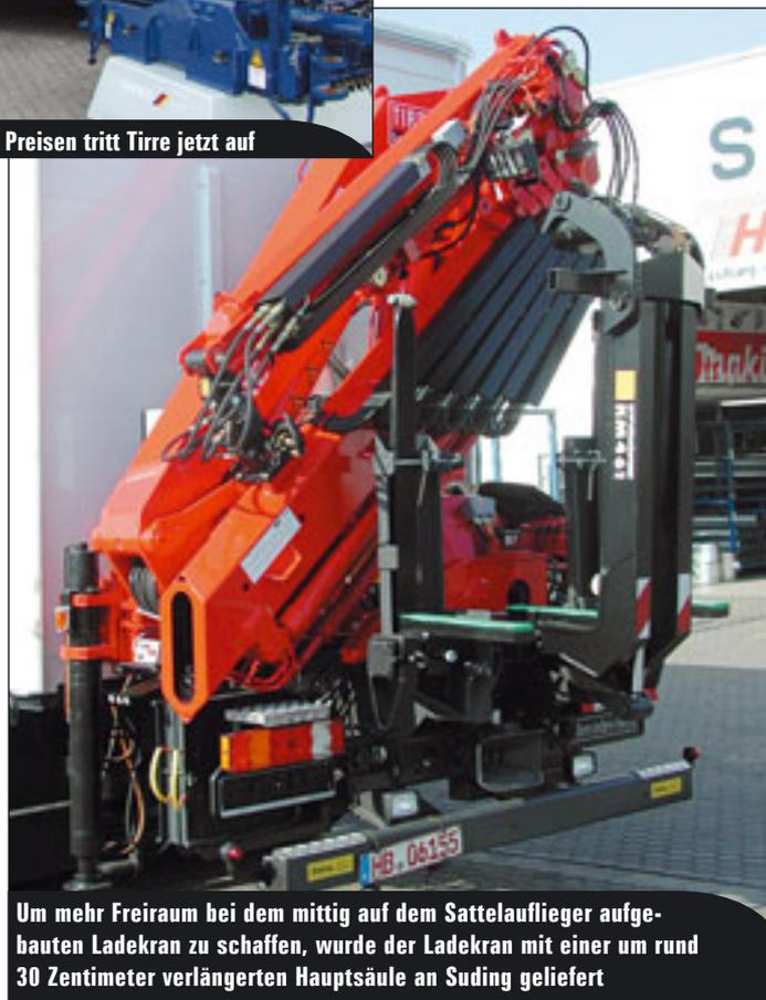
Um mehr Freiraum bei dem mittig auf dem Sattelaufleger aufgebauten Ladekran zu schaffen, wurde der Ladekran mit einer um rund 30 Zentimeter verlängerten Hauptsäule an Suding geliefert
