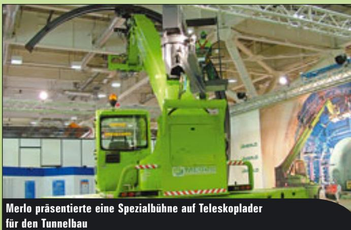
Merlo präsentierte eine Spezialbühne auf Teleskoplader für den Tunnelbau
