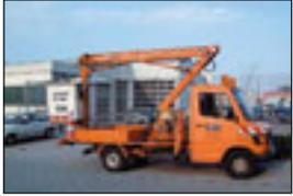
**LKW-Teleskopbühne Ruthmann KS 90 auf MB 307, Bj.: 1988**, Arbeitshöhe: 11,00 m, seilt.Reichweite: 5,80 m, Korbmaße: 1,20x0,60 m, Hublast: 150 kg, Gewicht: 3.500 kg, Diesel, hydraul. Stützen.
