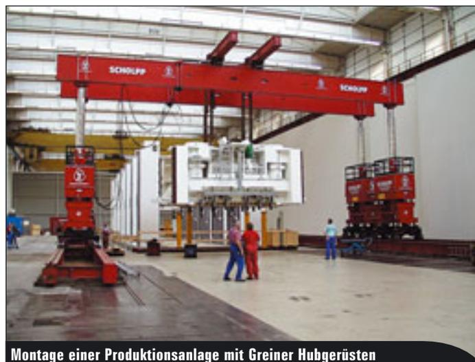
Montage einer Produktionsanlage mit Greiner Hubgerüsten
