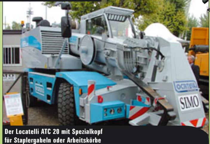
Der Locatelli ATC 20 mit Spezialkopf für Staplergabeln oder Arbeitskörbe
