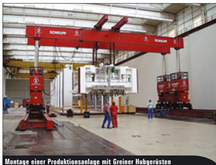
Montage einer Produktionsanlage mit Greiner Hubgerüsten
