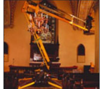
Kompakt, wendig und klein sind die markanten Merkmale des Leguan 125. Das 12,5-Meter-Gerät kann dank einem Eigengewicht von rund 1,3 Tonnen auch auf einem geeigneten Tandemanhänger an den Einsatzort gebracht werden.
