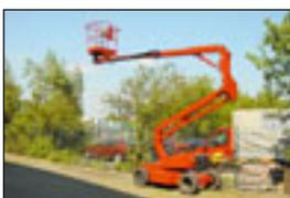
**Gelenkteleskopbühne Euro Access MZ 14-46 SP, Bj.: 2000**, Arbeitshöhe: 14,00 m, Korbmaße: 1,20x0,60 m, Hublast: 215 kg, Gewicht: 3.900 kg, Diesel, neuwertig.
