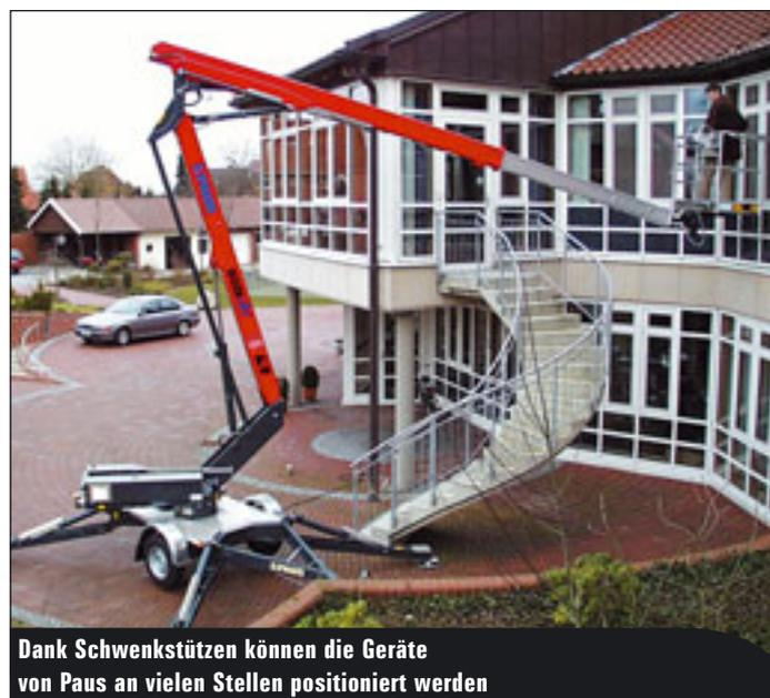
Dank Schwenkstützen können die Geräte von Paus an vielen Stellen positioniert werden
