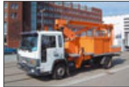
**LKW-Teleskopbühne Ruthmann T 130 auf Volvo FL 611, Bj.: 1986**, Arbeitshöhe: 15,00 m, seitl. Reichweite: 11,00 m, Korbmaße: 1,60x0,80 m, Hublast: 250 kg, Gewicht: 8.000 kg, Diesel, hydraul. Stützen
