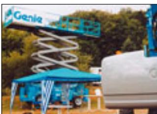
Aus dem breiten Sortiment an Selbstfahrern plant das Unternehmen die zwei Elektroschere GS 1932 und GS 2632 sowie die große Geländeschere GS 5390 mit Abstützung auszustellen. Neben einer großen Teleskoparbeitsbühne wird auch das Gelenkteleskop Z30/20 mit elf Metern Arbeitshöhe und 6,3 Metern Reichweite in Hohenroda vertreten sein.
