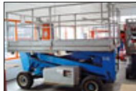
**Scherenbühne Genie V 2470, Bj.: 1997**, Arbeitshöhe: 9,30 m, Korbmaße: 3,35x1,78 m, Hublast: 550 kg, Gewicht: 2.500 kg, Batterie, ausziehbare Plattform.
