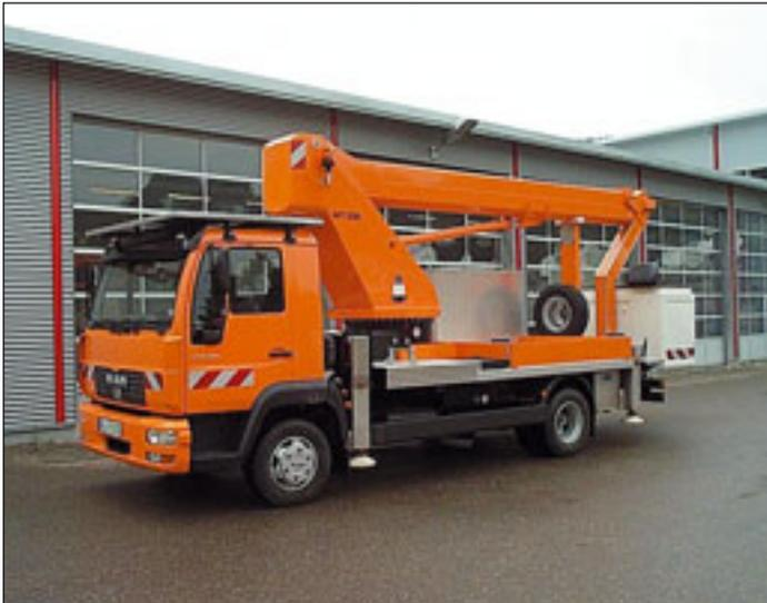
Die erste neuentwickelte Wumag WT 230 ist an das Vermietunternehmen Stütze-Späth ausgeliefert worden. Zwei weitere dieser Geräte hat das Unternehmen bei Wumag bestellt. Das 23 Meter-Gerät auf einem 7,5-Tonner aufgebaut bietet eine Reichweite von 17,5 Metern bei 300 Kilogramm Korblast. Mehr unter [www.Vertikal.net](http://www.Vertikal.net)
