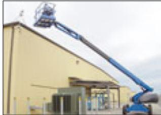
Die zur bauma vorgestellte neue Teleskopbühne mit 16 Metern Arbeitshöhe, die UI 46 SBJ mit 12,2 Metern Reichweite, steht ebenso auf dem Feld der Arbeitsbühnenräume in Hohenroda, wie die bereits bekannten Modelle AB 38 oder SL26. Der jüngste Spross des Unternehmens im Bereich der Anhängerbühnen, die TL 50, ist ebenfalls zu entdecken.
