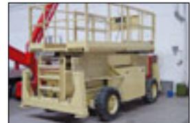
**Scherenbühne Grove SM 4688 XT, Bj.: 1995**, Arbeitshöhe: 14,20 m, Korbmaße: 4,20x2,32 m, Hublast: 680 kg, Gewicht: 4.800 kg, Diesel, Allrad, ausziehbare Plattform.
