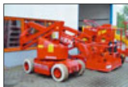
**Gelenkteleskopbühne Terex TA 30 N, Bj.: 1998**, Arbeitshöhe: 11,10 m, Korbmaße: 1,20x0,60 m, Hublast: 225 kg, Gewicht: 4.800 kg, Batterie, drehbarer Korb.
