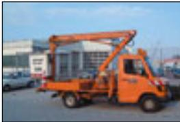
**LKW-Teleskopbühne Ruthmann KS 90 auf MB 307, Bj.: 1988**, Arbeitshöhe: 11,00 m, seitl. Reichweite: 5,80 m, Korbmaße: 1,20x0,60 m, Hublast: 150 kg, Gewicht: 3.500 kg, Diesel, hydraul. Stützen
