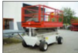
**Scherenbühne Holland Lift HL X 108 DL 18, Bj.: 1992**, Arbeitshöhe: 12,60 m, Korbmaße: 3,22x1,54 m, Hublast: 500 kg, Gewicht: 4.570 kg, Diesel, verschiebbare Plattform.
