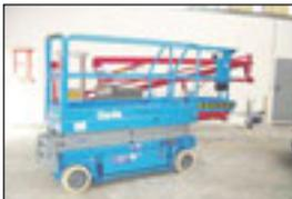
**Scherenbühne Genie GS 2032, Bj.: 2002**, Arbeitshöhe: 8,10 m, Korbmaße: 2,35x0,76 m, Hublast: 360 kg, Gewicht: 1.560 kg, Batterie, ausziehbare Plattform, schmale Bauweise.
