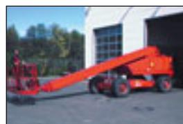
**Teleskopbühne Snorkel TBA 60 R 4x4, Bj.: 1994**, Arbeitshöhe: 20,30 m, Korbmaße: 2,40x0,76 m, Hublast: 230 kg, Gewicht: 9.600 kg, Diesel, Allrad, drehbarer Korb.
