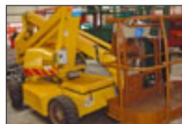
**Gelenkteleskopbühne Terex TA 33 E, Bj.: 1999**, Arbeitshöhe: 12,00 m, Korbmaße: 1,18x0,67 m, Hublast: 225 kg, Gewicht: 5.090 kg, Batterie, drehbarer Korb.
