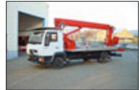
**LKW-Teleskopbühne GSR 220 TJ auf MAN 8.153, Bj.: 1996**, Arbeitshöhe: 22,00 m, seitl. Reichweite: 13,00 m, Korbmaße: 1,60x0,75 m, Hublast: 200 kg, Gewicht: 7.210 kg, Diesel, drehbarer Korb, Korbarm.
