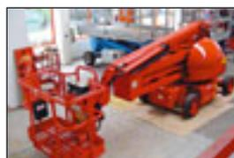
**Gelenkteleskopbühne Grove AMZ 46 NE, Bj.: 1996**, Arbeitshöhe: 14,30 m, Korbmaße: 1,22x0,76 m, Hublast: 227 kg, Gewicht: 6.080 kg, Batterie, drehbarer Korb, Korbarm.
