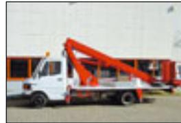
**LKW-Teleskopbühne Wumag WT 185 auf MB 410, Bj.: 1994**, Arbeitshöhe: 18,50 m, seitl. Reichweite: 9,50 m, Korbmaße: 1,23x0,83 m, Hublast: 200 kg, Gewicht: 4.300 kg, Diesel, schräge Stützen, ATM 2003
