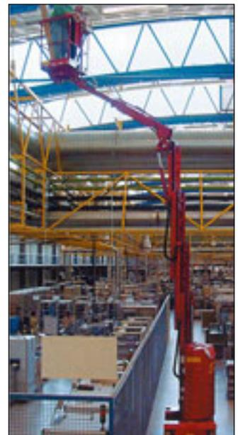
Erstmals als Aussteller mit dabei, zeigt das Unternehmen gleich eine Weltneuheit. Mit der EMU ST-K 1205 steht ein Personenlift mit zwölf Metern Arbeitshöhe und einer Reichweite von 5,15 Metern zur Verfügung. Das Gerät hat eine Spurbreite von unter einem Meter. Mit der
