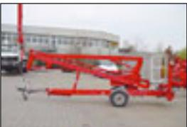
**Anhängerbühne Litra 120 G, Bj.: 2000**, Arbeitshöhe: 12,00 m, seitl. Reichweite: 4,50 m, Korbmaße: 1,05x0,66 m, Hublast: 215 kg, Gewicht: 1.200 kg, 220 Volt, hydraul. Stützen.
