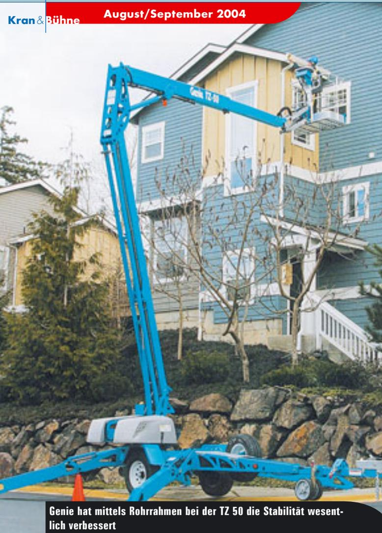
Genie hat mittels Rohrrahmen bei der TZ 50 die Stabilität wesentlich verbessert
