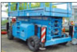
**Scherenbühne Haulotte H18SDX, Bj.: 2000**, Arbeitshöhe: 18,00 m, Korbmaße: 6,00x1,80 m, Hublast: 500 kg, Gewicht: 7.160 kg, Diesel, Allrad, ausziehbare Plattform.
