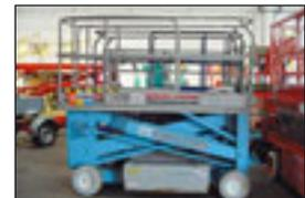
**Scherenbühne Upright SL 20, Bj.: 1996**, Arbeitshöhe: 8,10 m, Korbmaße: 2,53x0,74 m, Hublast: 340 kg, Gewicht: 1.405 kg, Batterie, Plattform ausziehbar.
