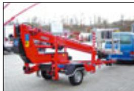
**Anhängerbühne Dino 150 T, Bj.: 2002**, Arbeitshöhe: 15,00 m, seitl. Reichweite: 10,00 m, Korbmaße: 1,30x0,70 m, Hublast: 215 kg, Gewicht: 1.620 kg, 220 Volt, hydraul. Stützen, Fahrtrieb.
