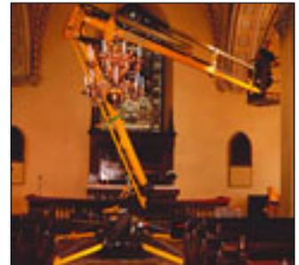
Kompakt, wendig und klein sind die markanten Merkmale des Leguan 125. Das 12,5-Meter-Gerät kann dank einem Eigengewicht von rund 1,3 Tonnen auch auf einem geeigneten Tandemanhänger an den Einsatzort gebracht werden.
