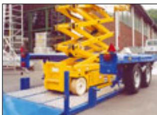
Transportlösungen für kleine Arbeitsbühnen stellt das Unternehmen vor. Neben dem absenkbaren Anhänger PT 18, der als Einachser 1,2 Tonnen Traglast bietet, wird der
