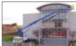
Mit einem neuen System für den Auslegerturm hat das Unternehmen den TVT 300 im Frühjahr vorgestellt. Der so genannte variable Turm ermöglicht es, die Baulänge zu verkürzen und bei der Arbeitshöhe etwas zu gewinnen. Begleitet wird das 30-Meter-Gerät von dem TB220 auf 3,5-Tonnen-Fahrgestell.
