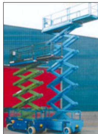
Im Frühjahr in München erstmals präsentiert, die neue N-165EL12 zu sehen. Die 18,5-Meter-Elektroschere hat eine Breite von 1,2 Metern und eine Korblast von 500 Kilogramm. Aus dem Elektroscherenprogramm stehen die Y-64EL14 und die X-105EL16 am Stand. Bei den Dieselscheren
