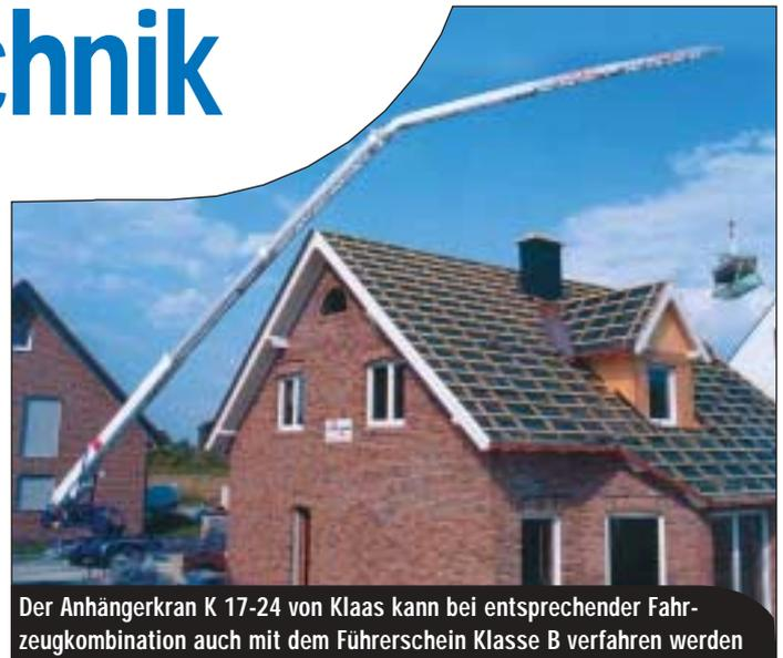
Der Anhängerkran K 17-24 von Klaas kann bei entsprechender Fahrzeugkombination auch mit dem Führerschein Klasse B verfahren werden
