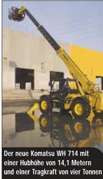
Der neue Komatsu WH 714 mit einer Hubhöhe von 14,1 Metern und einer Tragkraft von vier Tonnen
