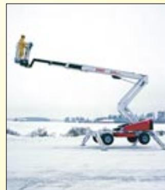
Dino Lift bringt eine Neuheit auf den Markt: die neue selbstfahrende Arbeitsbühne Rhino 240RXT mit hydraulischen Stützbeinen, entwickelt für anspruchsvolle Objekte und Gelände. Die Kombination von Teleskopausleger und Scherengelenk ermöglicht das Arbeiten auch über Hindernisse hinweg.
