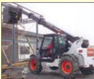
Bobcat hat den neuen 12-Meter Teleskoplader T 35120 für bis zu 3,5 Tonnen Nutzlast dabei. Besonderheiten an diesem Modell: die neue Auslegerkonstruktion, Verbesserungen bei der Fahrerkabine mit proportionaler Joystickbedienung sowie eine neu gestaltete Motorsektion mit einem emissionsarmen Tier II Dieselmotor.
