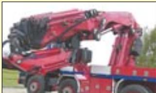
Fassi stellt den Prototyp einer neuen Kran-Serie bis 24 Meter tonnen vor. Für den Ladekran F1500 AXP.28 gibt es einen neuen überknickbaren hydraulischen Jib und für die Reihe F250A bis F450 AXP sind Versionen mit acht Hydraulikauszügen zu sehen.
