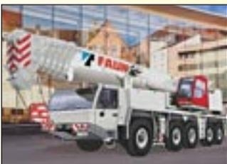
Tadano stellt die neuen Tadano Faun All Terrain Crane Typ ATF 160-5 und ATF 110-5 sowie den Geländekran GR-700 EXL aus. Der neue 5-Achser Tadano Faun ATF 160-5 verfügt über eine maximale Tragfähigkeit von 160 Tonnen und ist mit einem 60 Meter Ausleger mit einem 1-
