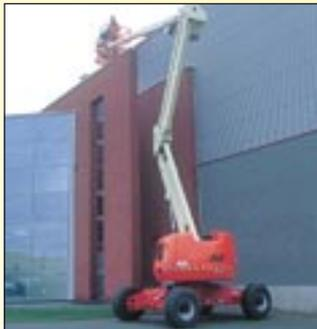
JLG präsentiert die neue Gelenkteleskopbühne 1250 AJP mit einer Arbeitshöhe von 40 Metern und einer seitlichen Reichweite von 19,25 Metern. Ebenfalls neu: das Modell 510AJ mit 18 Meter Arbeitshöhe.
