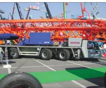
Mit dem Modell AF 38 bietet Arcomet erstmals einen Turmdrehkran aufgebaut auf einem dreiachsigen Faununterwagen an. Der Kran hat eine Hakenhöhe von 23 Meter bei horizontal gerichteten Ausleger und 43,5 Meter bei 30 Grad Steilstellung. Die Auslegerlänge beträgt 38 Meter, die maximale Traglast gibt der Hersteller mit sechs Tonnen an, an der Spitze noch 1,8 Tonnen.
