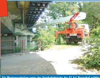
Für Montagearbeiten unter der Autobahnbrücke der A1 bei Neuenhof wählte die Elektroinstallationsfirma Erni+Giger eine Bison TKA 35 KS der Lift-Ex AG. Dabei kam die volle Reichweite von 30 Metern zum Einsatz.
