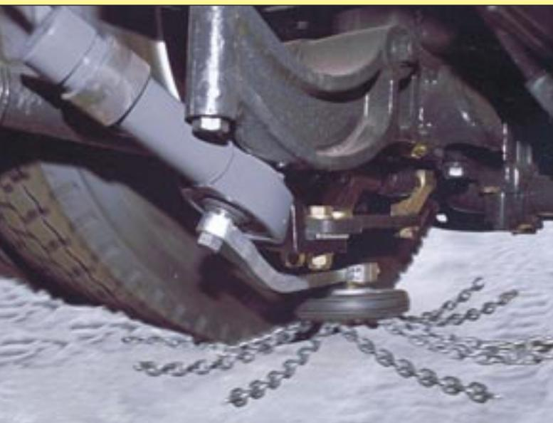
Immer wieder wird im Winter der Einsatz von Schneeketten in höheren Lagen notwendig. Um den Einsatz der dann notwendigen Schneeketten zu beschleunigen, bietet Rud seine so genannten Rotationsketten an. Während der Fahrt kann das System einfach zugeschaltet werden. Die Ketten werden, dem Tempo angepasst, regelrecht unter den Reifen geschleudert und so der Grip erhöht. So kann der Fahrer relativ schnell auf neue Straßenverhältnisse umstellen.
