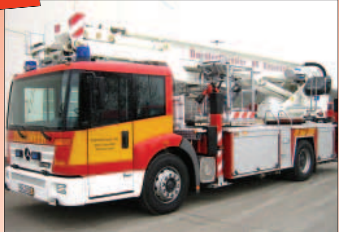
Einen neuen Bronto TLK 23-12 wurde in diesen Tagen an die Werksfeuerwehr DaimlerChrysler Standort Düsseldorf ausgeliefert. Das Gerät ist auf einem MB Atego 1828 LL/4500 aufgebaut und erreicht eine Arbeitshöhe von 32 Metern. Die maximale Reichweite beträgt 18,4 Meter. Eine Korblast von 325 Kilogramm bietet die Maschine. Die installierte Wasserleitung hat einen Einspeisedruck von 16 bar. Der ferngesteuerte Monitor bringt eine Leistung von 2300 l/m.
