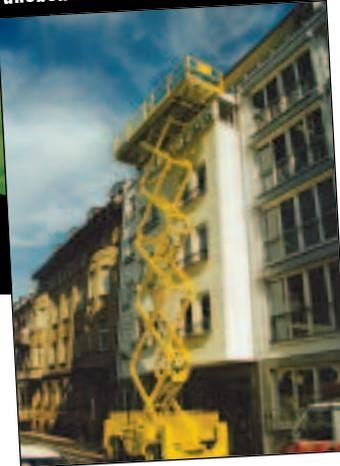
« im Südwesten, ist ein Depot bei Köln eingerichtet worden und ein weiteres wird im Großraum Bremen etabliert werden. Die jüngste Generation an Dieselschere ist die Compact-Serie mit drei Größen von acht bis zwölf Metern Arbeitshöhe. Für eine gute Traktion sorgt eine hydraulische Differentialsperre. Als Sonderausstattung können hydraulische Abstützungen hinzugenommen werden.
