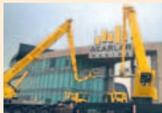
Acht AK44/4000 für Ainscough: Böcker liefert gleich acht Alu-Autokrane vom Typ AK44/4000 an den größten Kranvermieter in Großbritannien. Der Kran mit 44 Metern Hubhöhe verfügt über vollvariable Abstützung und eine Funkfernsteuerung. Der für UK zuständige Distributor Kranlyft
