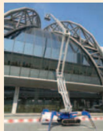
↑ Der thailändische Hauptstadtflughafen Bangkok International Airport hat gleich vier neue 32-Meter-Raupenarbeitsbühnen vom Typ Falcon Spider FS320Z erhalten. Die diesel-elektrisch angetriebenen Modelle bieten bis zu 15 Metern Reichweite und eine Übergriffweite von maximal zehn Metern. Die neuen „Falken“ werden zur Reinigung und Instandhaltung der Glasfassaden eingesetzt.
