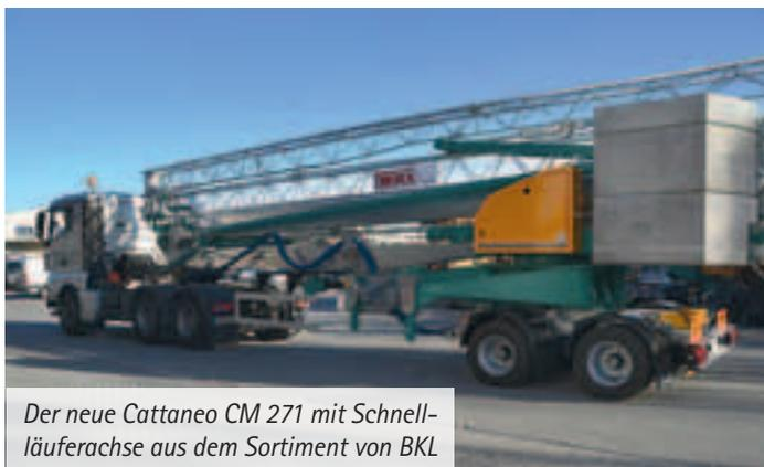
Der neue Cattaneo CM 271 mit Schnellläuferachse aus dem Sortiment von BKL
