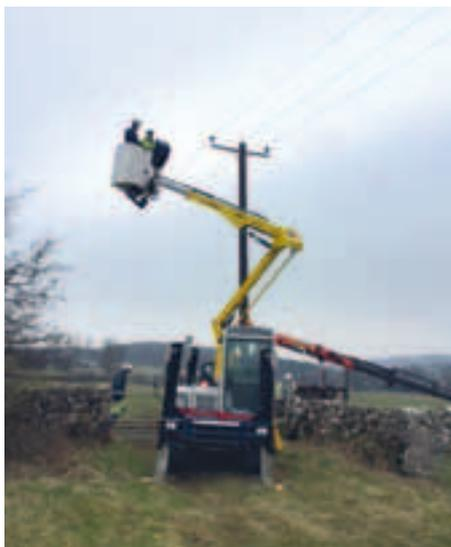
» Für den britischen Energieversorger Electricity North West setzte Versalift UK einen Bühnenaufbau auf ein Raupenfahrzeug von Takeuchi. Statt der ursprünglichen Mulde für den Raupendumper TCR 50 kommt ein vollhydraulisches Gelenkteleskop vom Typ LAT-38-140-H zu Ehren. Mit zwei paarweisen A-Abstützungen kann die Maschine auch auf extrem unwegsamem Gelände ausnivelliert werden.
