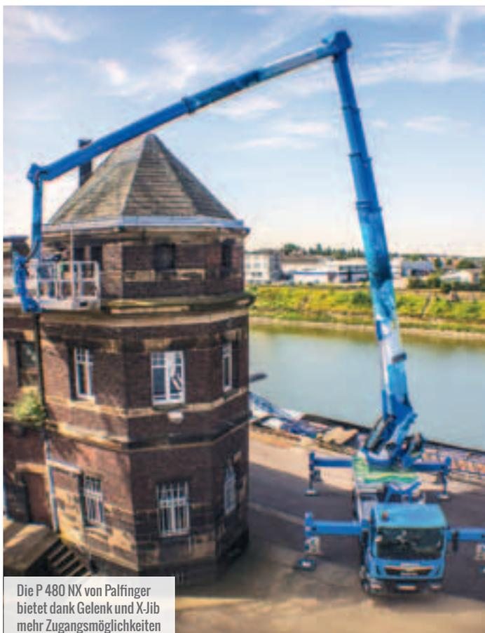
Die P 480 NX von Palfinger bietet dank Gelenk und X-Jib mehr Zugangsmöglichkeiten
