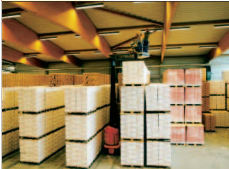
Die Südzucker AG aus Mannheim setzt für schnelle Instandhaltungsarbeiten auf eine Maniaccess 105 VJR mit 10,5 Meter Arbeitshöhe und 3,2 Meter Reichweite. „Diese Arbeitsbühne ist schmaler als die bei uns üblichen Europaletten“, erklärt Günter Leinfelder, Elektromeister bei Südzucker. Darüber hinaus sei das Handling der 99 Zentimeter breiten Maschine einfach, so Leinfelder weiter.
