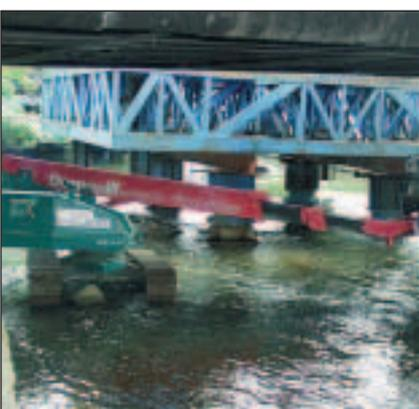
Für den regelmäßigen Einsatz zur Brückeninspektion kam die Aichi SR 123 der Firma Spielhoff, Ringliftpartner aus Wuppertal, zum Einsatz. Das Raupengerät, ausgestattet mit Kranösen, wurde von einem Kran in den Fluß Wupper gesetzt. Ein Einsatz bis einem Meter Flußtiefe ist laut Hersteller mit der 14,2-Meter-Maschine machbar. Das Kettenfahrwerk erlaubt ein Fahren in dem unebenen Flußbett.
