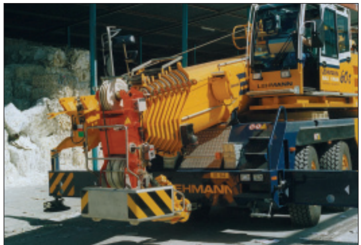
Der AC 60, hier das Gerät des Schweizer Unternehmens Lehmann aus Moudon, ist die jüngste Entwicklung von Demag. Der 9,88 Meter kompakte Kran hat eine maximale von 63,4 Metern. Demag liegen derzeit rund 100 Aufträge für den AC 60 vor, die zum größten Teil alle noch in diesem Jahr ausgeliefert werden sollen.
