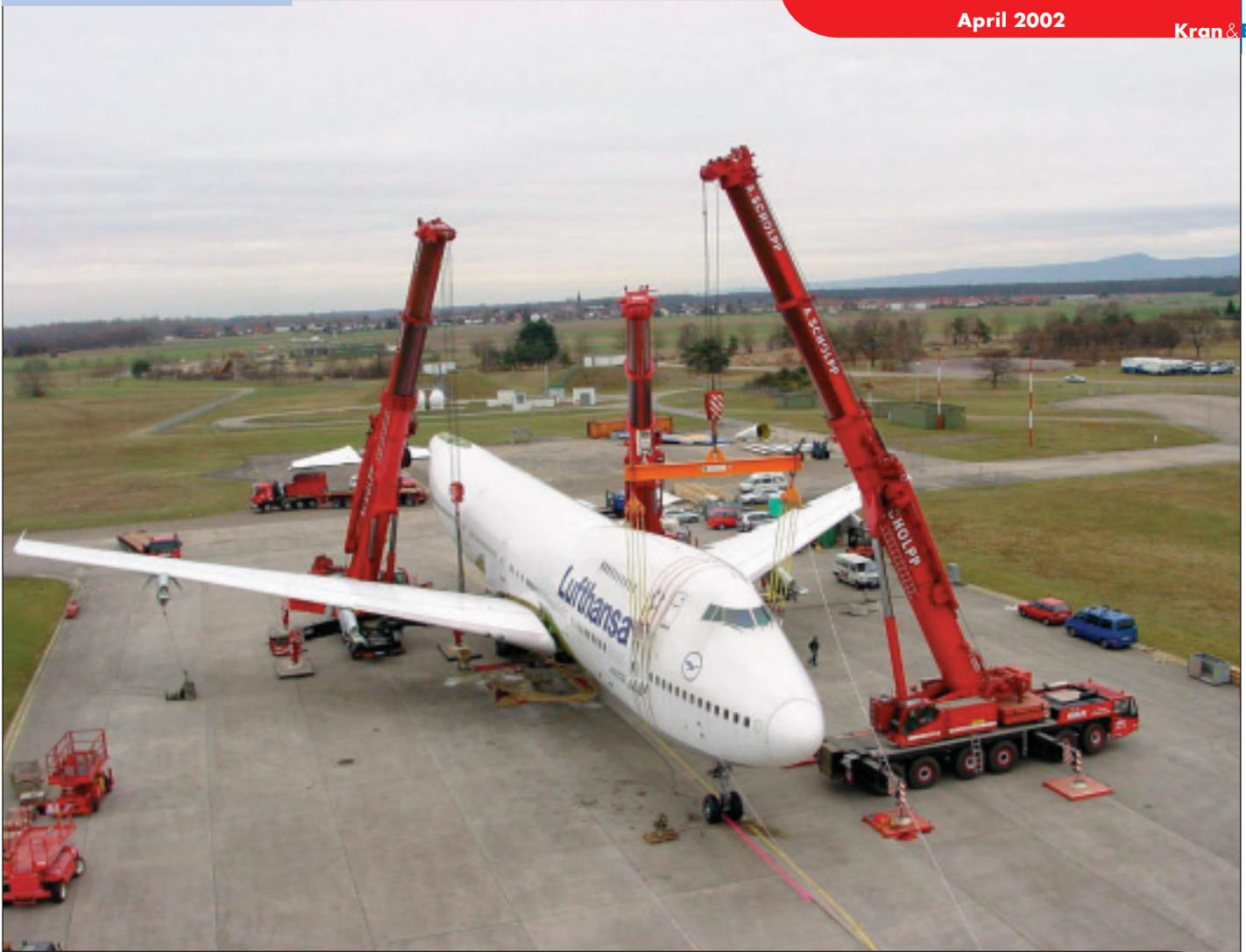
Für den Transport eines Jumbo-Jets vom Baden Airport Söllingen bei Karlsruhe in das Technikmuseum Speyer mussten dem Flugzeug die „Flügel gestutzt“ und das Fahrwerk eingefahren werden. Um die Arbeiten durchzuführen, haben drei Mobilkrane der Firma Scholpp den 130-Tonnen schweren Flieger gemeinsam angehoben und auf ein Gerüst gesetzt. Neben einem Demag AC 500-1 und Demag AC 300 kam ein Demag AC 650 zum Einsatz.
