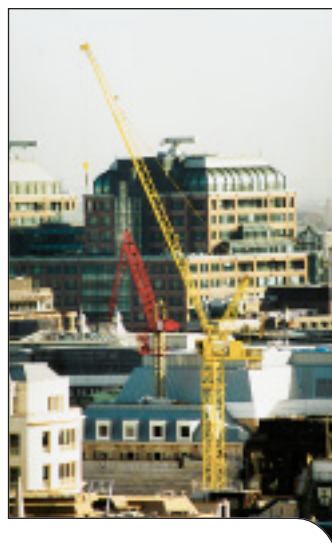
Der Tornborgs mit Knickausleger (im Hintergrund) gemeinsam mit einem Wolf 100B sind bei Stadtbau- stellen sehr beliebt
