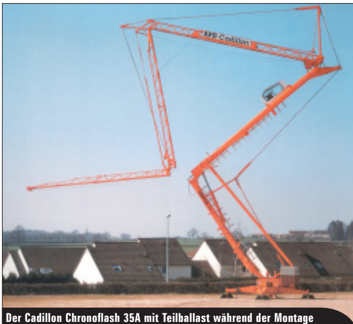
Der Cadillon Chronoflash 35A mit Teilballast während der Montage
