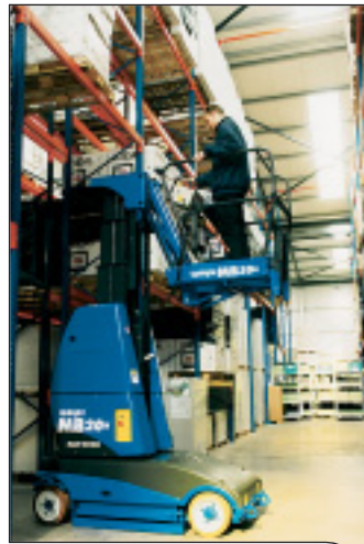
Das dritte Modell der MB-Reihe von Upright, die 20N mit acht Metern Arbeitshöhe und 99 Zentimetern Breite
