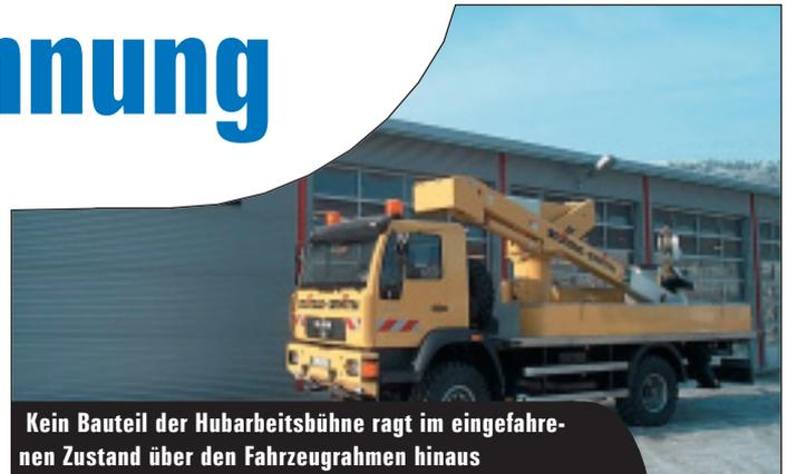
Kein Bauteil der Hubarbeitsbühne ragt im eingefahrenen Zustand über den Fahrzeugrahmen hinaus
