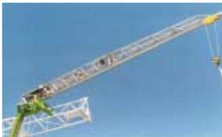
Mit dem installierten Hubwerk kann er bis zu einer Ausladung von 8,8 Metern Lasten bis zu 800 Kilogramm heben. Die Tragfähigkeit an der Spitze beträgt 400 Kilogramm. Der zusätzliche Ausleger vergrößert den Arbeitsbereich der Maschine um 9,5 Meter. Dieser neue Zusatz ist allerdings zur Zeit nur für den neu entwickelten Roto-40.21 EVS einsetzbar.
