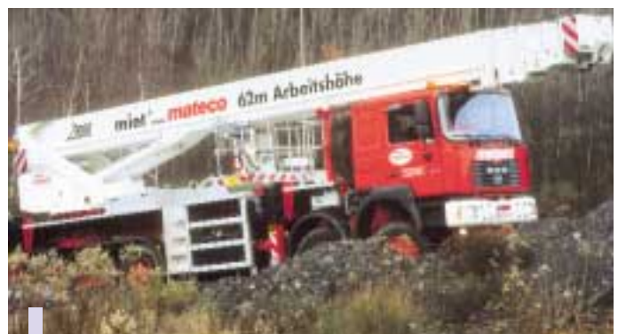
Matecos Allrad-LKW-Arbeitsbühne LT 620 K D 4x4 für Anwendungen in schwierigem Gelände
