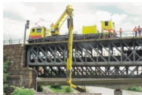
das Gerät mit Schrittgeschwindigkeit gefahren werden. Die Reichweite nach oben und unten liegt bei fast 30 Metern. Ein hydraulisch ausklappbares Gegengewicht schließt dabei ein seitwärts Kippen aus. Der Arbeitskorb ist 90 Grad nach rechts und links drehbar.
