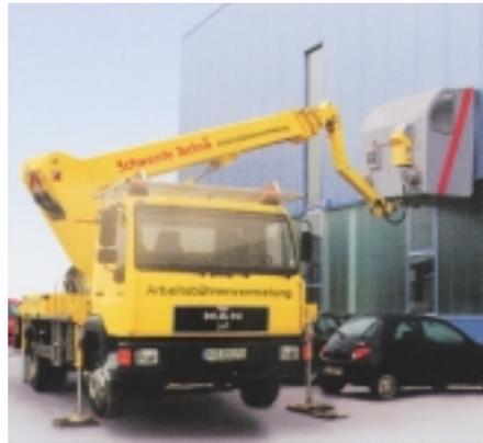
Schwemle Technik bietet eine neue Fassadenspritztechnik auf einer Arbeitsbühne an. Unter dem Namen Skyprimus bietet der Arbeitsbühnenvermieter seine neue Technologie an. Die Kabine aus Kohlefaser, ausgestattet mit einem luftlosen Spritzverfahren, kann nach Aussagen des Unternehmens eine Fassade mit einem Arbeitsgang flächig deckend beschichten. Schwemle spricht von einer Qualität ähnlich einer Autolackierung.
