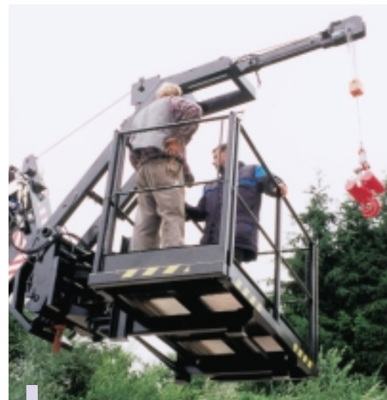
Der Hercules Teleskoplader bietet Galgen und Bühne gleichzeitig
