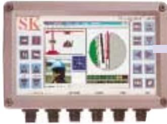
Prüf- und Warnsysteme von SK Group zum Kollisionsschutz von Baustellenkränen
