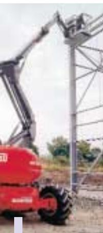
Manitou Maniaccess 165 ATJ mit einer Arbeitshöhe von 16,5 Metern.
