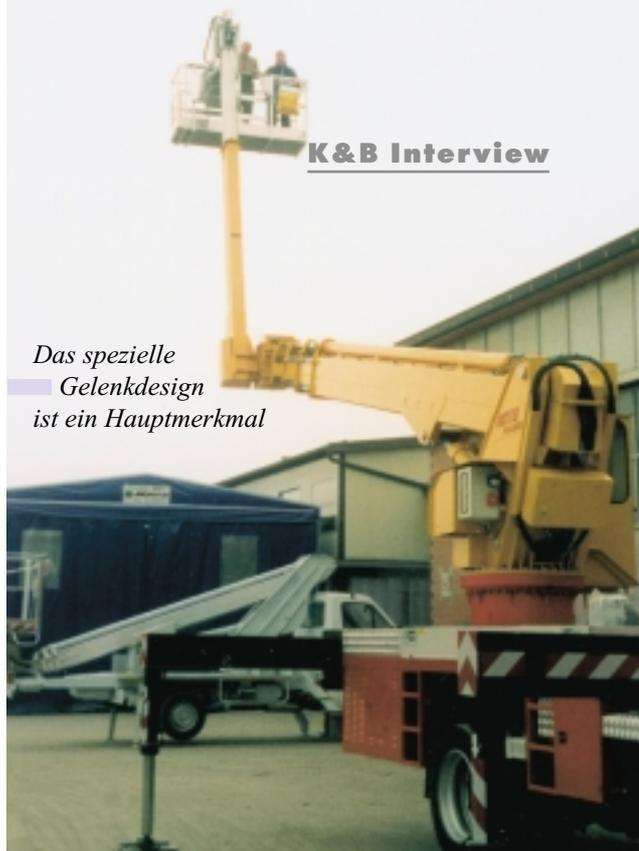
wählen. Bei einigen Modellen kann sich der Käufer zwischen einer Korbkapazität von 400 Kilogramm oder 280 Kilogramm entscheiden – das System bestimmt automatisch die Maximalhöhe und verlangsamt die Auslegerbewegung, wenn das Sicherheitslimit erreicht ist.
