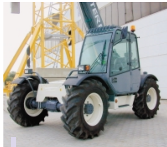
Terex bietet bei seinem Modell Agrilift 359 serienmäßig Vorderradlenkung, Hundegang und Kreisfahrt an.
