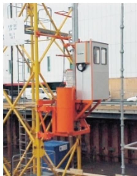
Der Kranführer erreicht seinen Arbeitsplatz in einem Bruchteil, der sonst benötigten Zeit. Neben der eingesparten Zeit besteht auch die Möglichkeit einer besseren Motivation, da der Kranführer nicht mehr partout die ganze Schicht isoliert von der Außenwelt ist, da er innerhalb von wenigen Minuten von der Kabine aus den Boden erreicht, beziehungsweise wieder an seinen Arbeitsplatz zurückkehren kann.
