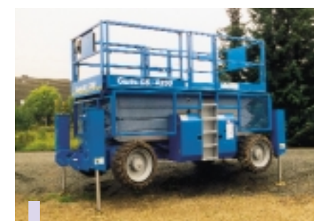
Eine Steigfähigkeit von 50 Prozent zeichnet die neuen Geländemaschinen von Genie aus.
