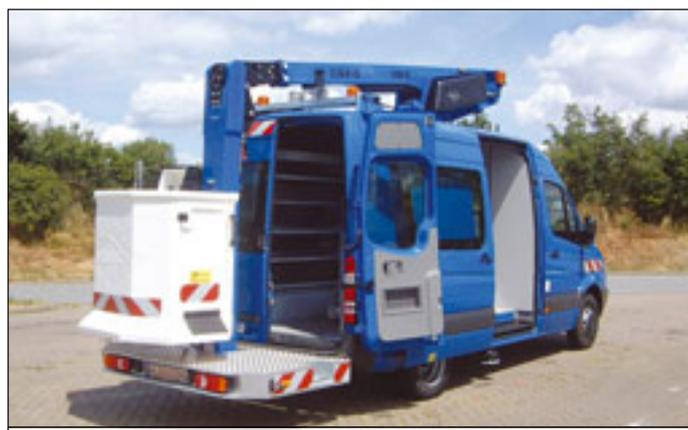
Die Bühnen von Time Versalift können auch auf Fahrzeuge mit Erdgasantrieb aufgebaut werden
