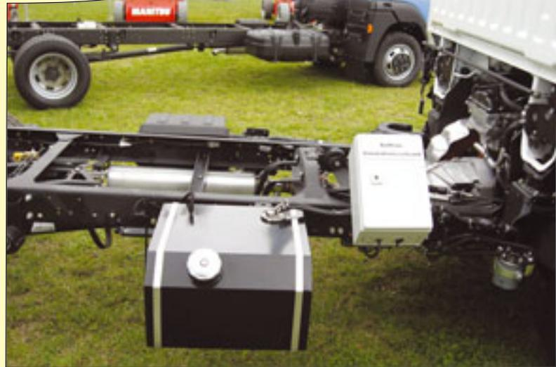
Der Unterwagen kann auch mit einem kleineren Tank ausgestattet werden
