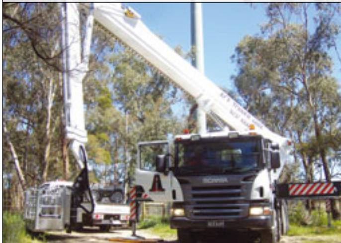
kommt mit 78 Metern Arbeitshöhe in die Nähe und die 37 Meter Reichweite lassen sich auch sehen. Die zulässige Korblast liegt, wie bei der gesamten XDT-Reihe, bei maximal 700 Kilogramm. Der Korb lässt sich einseitig erweitern. Die Baureihe ist so ausgelegt, dass die Transportbreite immer bei 2,5 Meter liegt und die Bauhöhe unter vier Meter bleibt.
