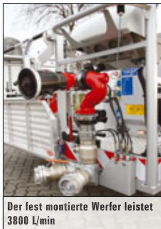
Der fest montierte Werfer leistet 3800 L/min
