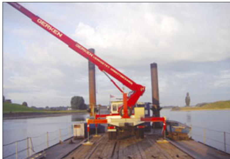
wurden. Während des Einsatzes stemmten sich diese Stützen gegen den Boden des Hafenbeckens und stabilisierten den Ponton für einen schaukelfreien Einsatz der
