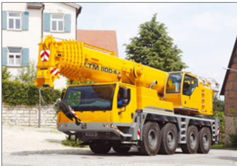
Mit dem neuen LTM 1100-4.2 bringt Liebherr den Nachfolger des auf der Intemat 2003 präsentierten LTM 1100-4.1 auf den Markt. Mit einer Teleskopauslegerlänge von 60 Meter übertrifft der Neue seinen mehr als 350 Mal gebauten Vorgänger um acht Meter. Gleichzeitig verfügt er über mehr Tragkraft. Insbesondere bei
