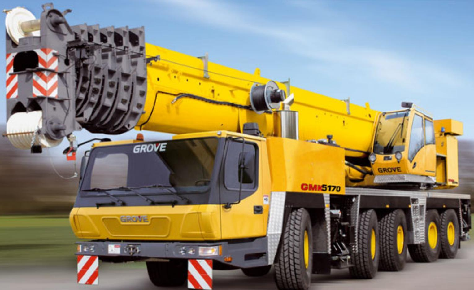
Der neue Grove 5170 verfügt über einen sechsteiligen TWIN-LOCK-Ausleger und hat eine maximale Tragkraft von 170 Tonnen. Beim Einsatz der optionalen Klappspitze erreicht dieser Fünffachser-Mobilkran eine maximale Rollenhöhe von 101 m.
