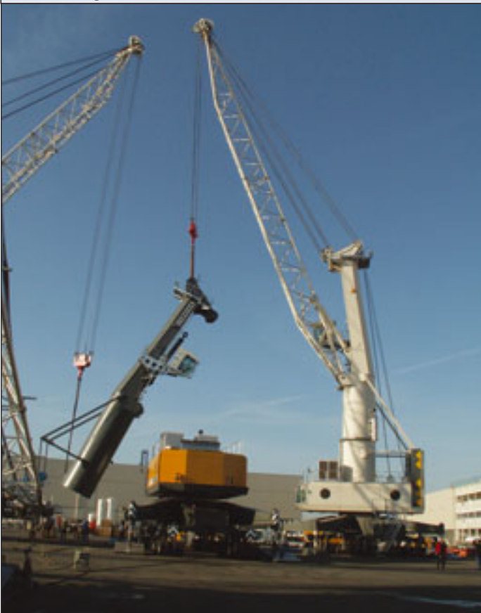
Die Endmontage eines Hafemobilkrans in Rostock
